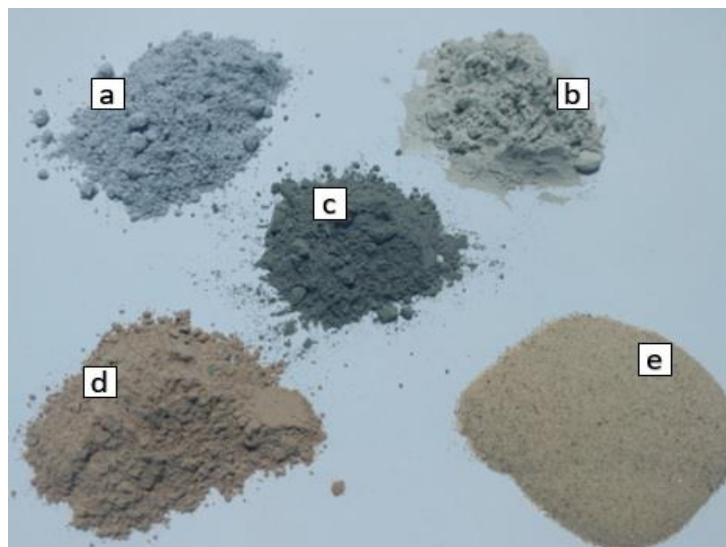
Fig. 2. Used material: (a) silica fume, (b) GGBFS, (c) cement, (d) micro silica, (e) silica sand.
